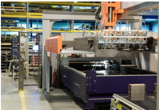
Figur 2: Bystronic-laser som skjærer opp til 12 mm tykke plater av rustfritt stål.
